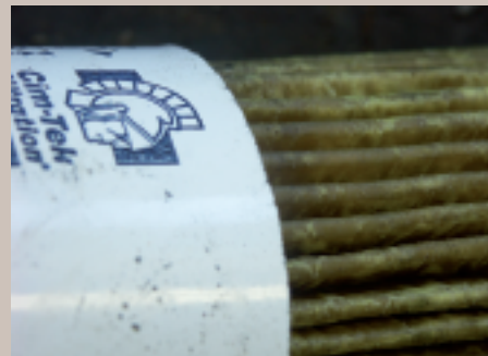
Een veel voorkomend probleem is deze witte paraffine-achtige aanslag op Cim-Tek-filters van de brandstof-opslag. Dat zou volgens de filteranalyses van de industrie niet mogen kunnen. Zonder nadere analyse is het gevaarlijk een verklaring te geven, maar het wijst sterk richting biocomponenten.
