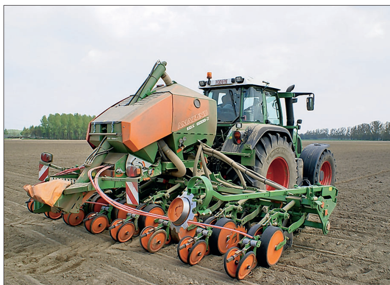
De gloednieuwe EDX 6000-2 snelzaaimachine van Amazone is compact gebouwd, instelbaar vanuit de cabine en heeft een hoge capaciteit. De voorraad maïszaad zit in één tank in plaats van in acht individuele zaadbakjes.
