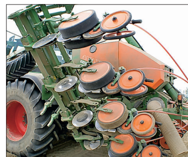
Voor transport klappen telkens twee balken met vier zaai-elementen omhoog.
