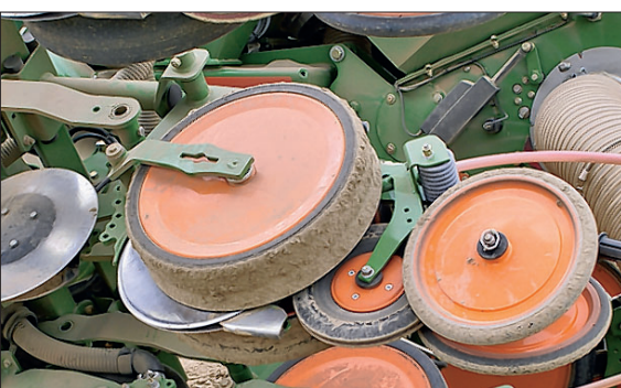
Zicht op het zaai-element. Via het kleine gaatje in de kouter komt het maïszaad d.m.v. een luchtstroom in de zaai-geul terecht, waarna het wordt aangedrukt en de geul gedicht.
