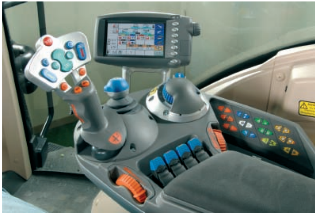
De bediening van de Variotransmissie verloopt hoofdzakelijk via de rijhendel op de armleuning en het rijpedaal. Men kan verschillende manieren van rijden kiezen.
